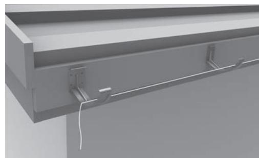
In der Abbildung sehen Sie die Montage von DDC Träger Typ H am Stirnbrett. Das gleiche Vorgehen wird bei allen am Stirnbrett befestigten Träger angewandt.
