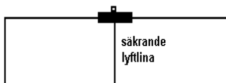
Bild 9 Korta och lätta element kan lyftas med en lyftanordning från mitten av elementet. Det kortaste elementet som kan lyftas med en lyftanordning är 0.5 m.
