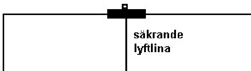
Bild 4. Korta och lätta element kan lyftas med en lyftanordning från mitten av elementet. Det kortaste elementet som kan lyftas med en lyftanordning är 0.5 m.
