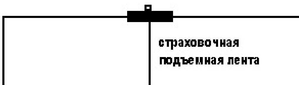
Рис. 4. Короткие и легкие элементы можно поднимать одним подъемником за середину. Длина наиболее короткого элемента, который можно поднимать одним подъемником, равна 0,5 м.
