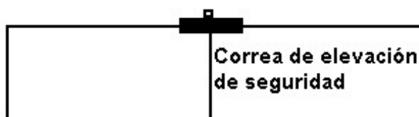
Figura 3. Las elevaciones de elementos largos y pesados efectuadas con dos elevadores, se realizan utilizando un brazo. La zona libre tras el extremo del elevador ha de tener un metro como mínimo. Esto garantiza que la sujeción de la lengüeta y la ranura, la forma de éstas y el dispositivo de sujeción, se mantengan durante la elevación.
