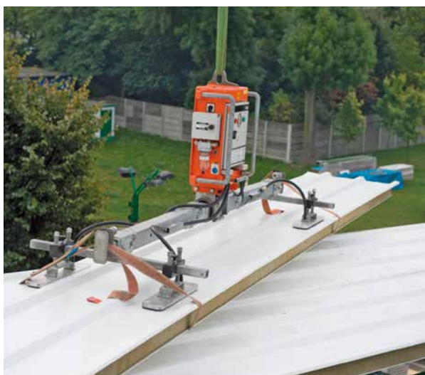
Obr. 1 a 2 Zdvíhacie zariadenie VIAVAC
