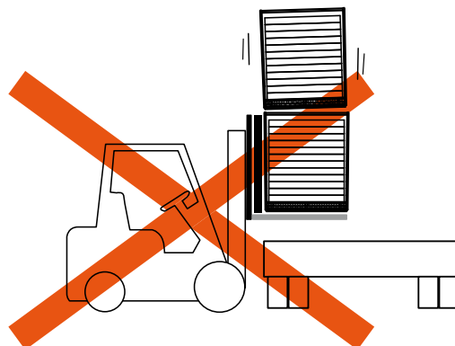
Obr. 7 Balíky by sa mali vykladať jeden po druhom. Dvíhanie dvoch balíkov naraz môže poškodiť prvý panel v prvom balíku.
