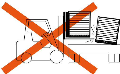
Obr. 6 Príliš dlhé vidlice môžu poškodiť druhý rad balíkov.
