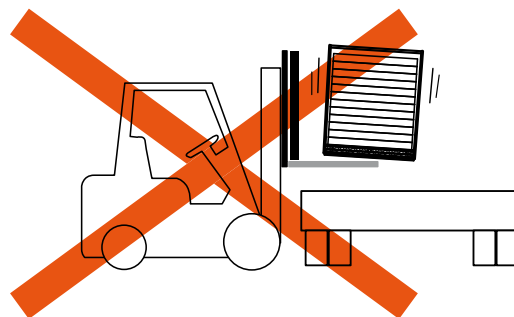
Obr. 5 Příliš krátké vidlice mohou poškodit balík.
