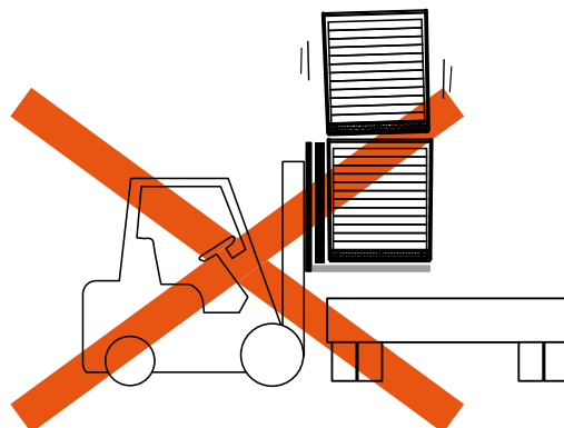
Obr. 7 Balíky by se měly vykládat jeden po druhém. Zvedání dvou balíků najednou může poškodit první panel v prvním balíku.
