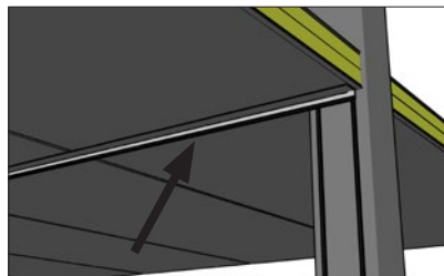
Kiinnikkeet ja tiivistenauha yläreunan tukiorren sisälaippaan
