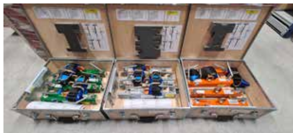
Fot. nr 3. Samozaciskowe narzędzia montażowe: od lewej: PTH 2006, PSP 2011, PTH2022.
